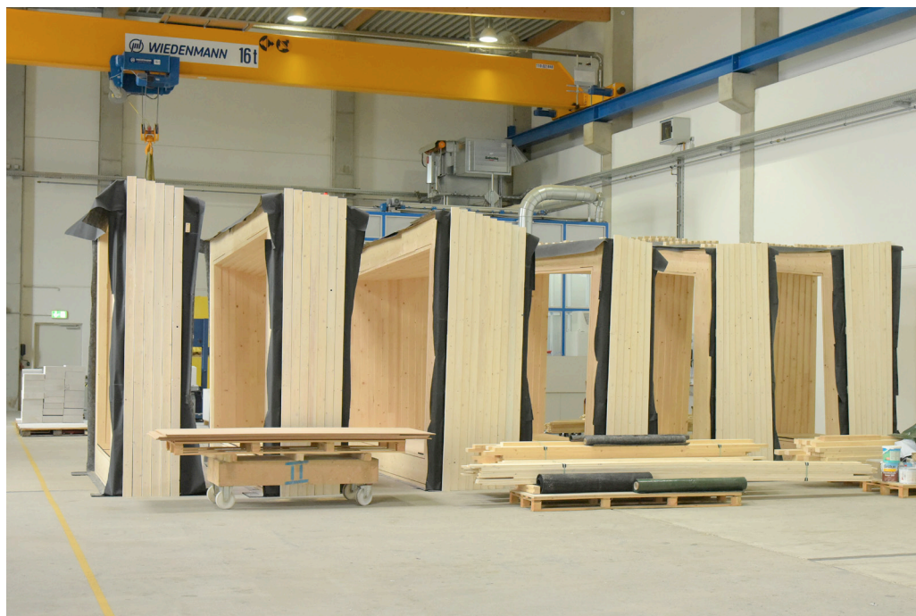
Timber Prototype House, Vorfertigung als Raummodule / © ICD Stuttgart, Foto: Oliver Bucklin
